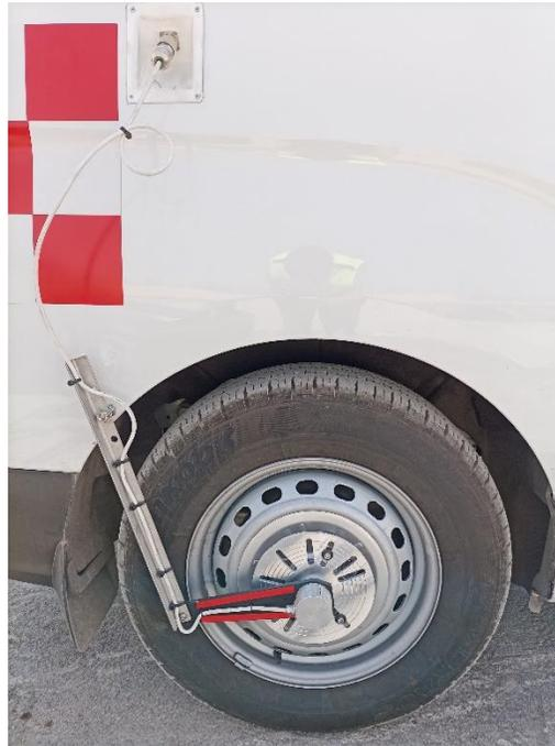
Ilustración 8. Partes del encoder y montaje final
