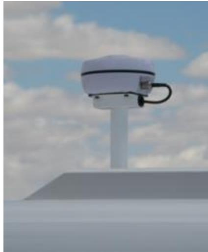
Ilustración 5. Antena externa del sistema de posicionamiento
